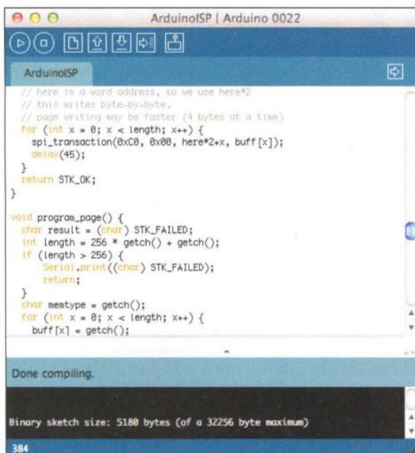
Obr. 2. Vývojové prostředí. Jedním tlačítkem se program přeloží a druhým nahraje přes USB do Arduina
