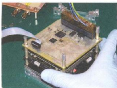
Rozpracovaný prototyp satelitu FUNcube
